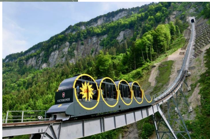
F 112: die Stoosbahn mit 110 % Steigung (Garaventa)
